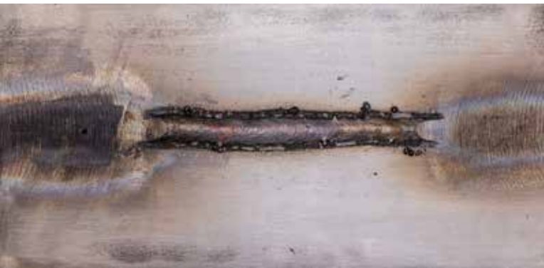
Konventionell entstehen Anlauffarben/Oxidation infolge eines hohen Wärmeeintrags.
