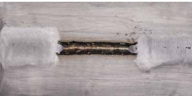
Mit der neuen Co-Freeze SG Inox bildet sich wegen der geringeren thermischen Belastung keine Blaufärbung.
