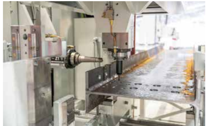
Die neue HDX bohrt und fräst Stahlträger mit hoher Geschwindigkeit.
